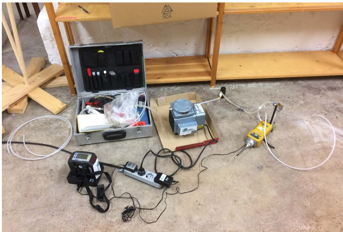
Figur 1. Porgasprovtagning i källare till byggnad BC.
